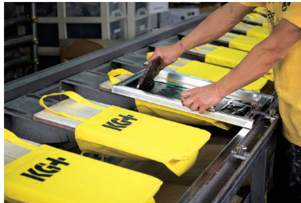
ハイクリエイティブ工房でのトートバッグ製作過程 Tote bag-making process at the HiCREATIVE atelier
